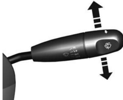
Para usar los limpiaparabrisas, primero gire el interruptor de ignición a la posición ON (encendido), y empuje la palanca de lava/limpiaparabrisas hacia arriba.
