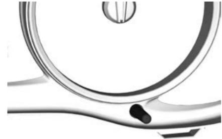
El vástago de restablecimiento de DIC está ubicado en la esquina inferior derecha del cuadro de instrumentos. Puede presionarlo para cambiar o restablecer las opciones del menú en la pantalla.
