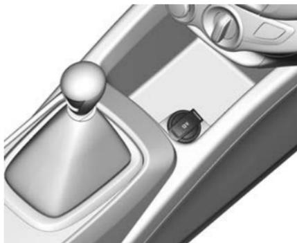
Si está equipado con tomacorriente, el vehículo tiene un tomacorriente de 12 voltios que se pueden usar para conectar equipo eléctrico, como un teléfono celular o un reproductor MP3.
