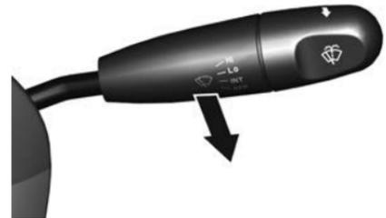
Jale la palanca de control para rociar fluido de lavador sobre el parabrisas, y opere los limpiadores para limpiar una vez.
