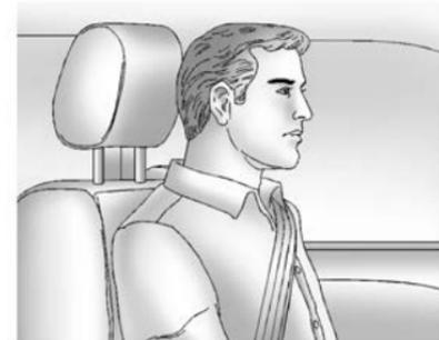
Ajuste las cabeceras de tal forma que la parte superior de la misma esté a la misma altura que la parte superior de la cabeza del ocupante. Esta posición reduce la probabilidad de una lesión de cuello durante un accidente. Puede ajustarse la altura de la cabecera.
