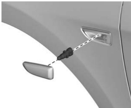
1. Utilice una herramienta plana para sacar cuidadosamente el receptáculo del foco del borde de la luz direccional delantera.
