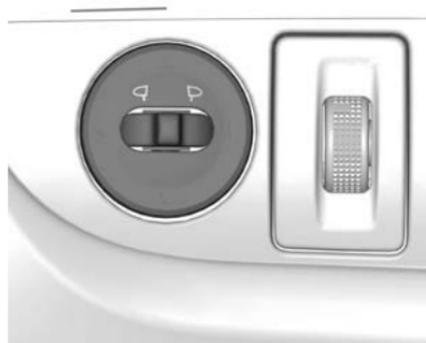
Los espejos exteriores se pueden ajustar en cuatro direcciones usando el interruptor del espejo que está ubicado en el tablero de instrumentos en el lado izquierdo del volante. El interruptor de ignición debe estar encendido o en ACC/ACCESSORY (accesorios) para que opere esta función.
