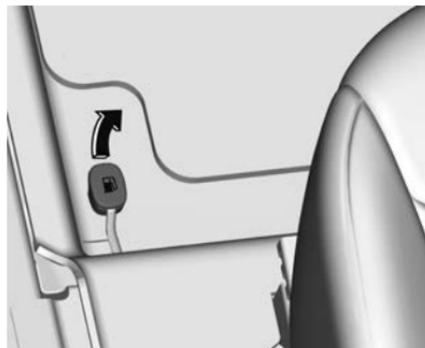
Para abrir la puerta de llenado de combustible, levante la palanca de liberación de la puerta de combustible. La palanca está en el suelo, en la parte delantera izquierda del asiento del conductor.
